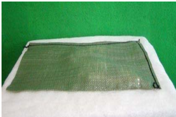
† 포대 안에 SAP(고흡수성수지) 성형물을 충전한 상태와 물에 팽윤한 5분 후 모습(무게 6kg)
