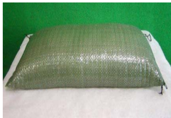
† 포대 안에 SAP(고흡수성수지) 성형물을 충전한 상태와 물에 팽윤한 5분 후 모습(무게 6kg)
