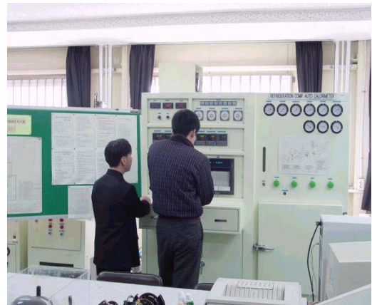
열량계를 이용한 신냉매 성능평가실험
